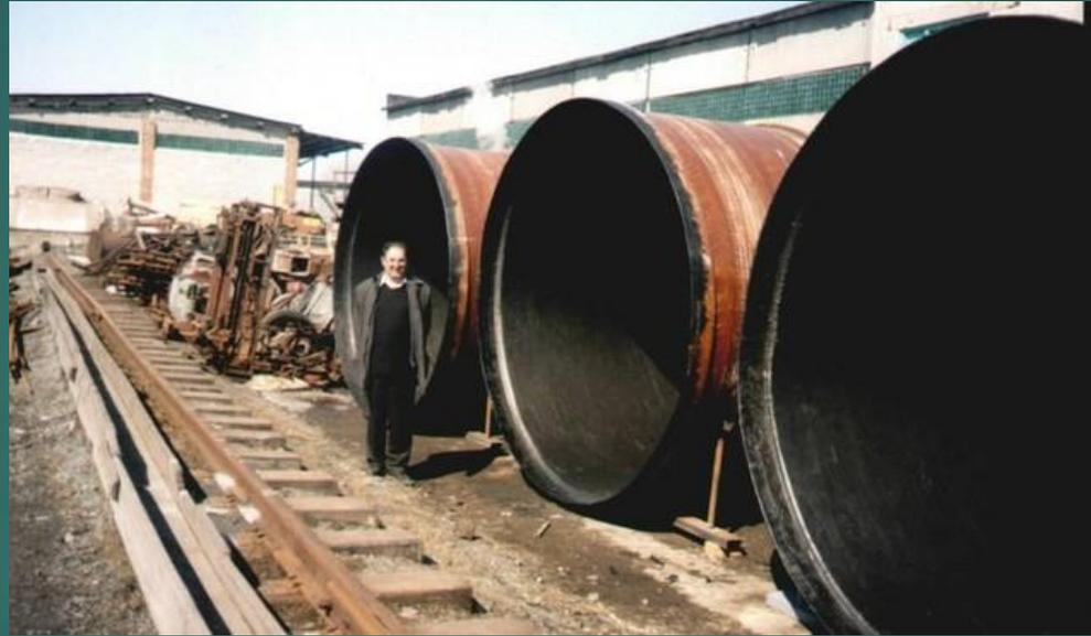
Рис 5. Стеклопластиковые трубы газопроводов, защищенные композитами «Ремохлор»
