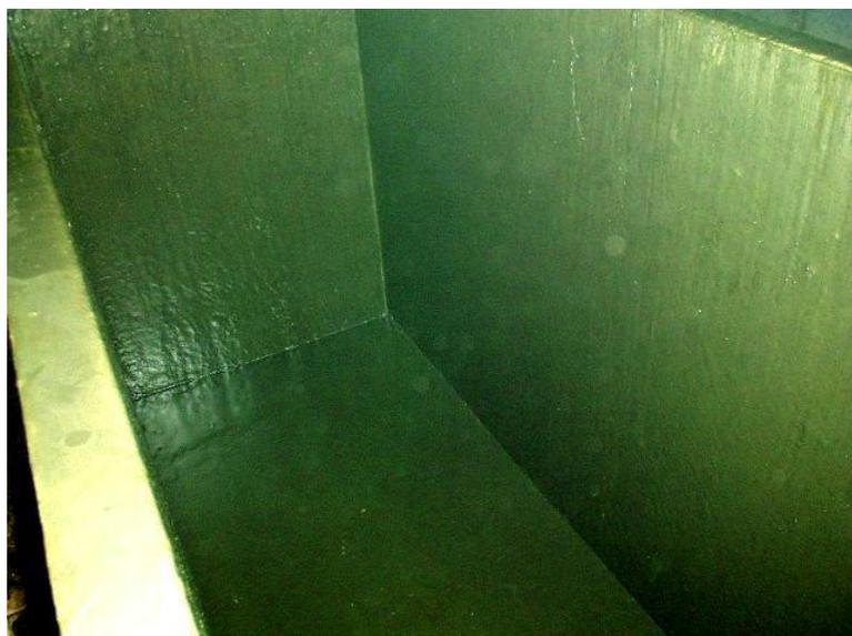
Гальваническая ванна с покрытием «Ремохлор»
