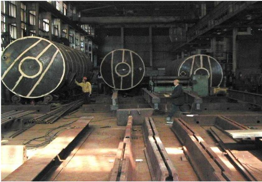
Емкости объемом 100 куб.м., защищенные покрытиями «Ремохлор»
