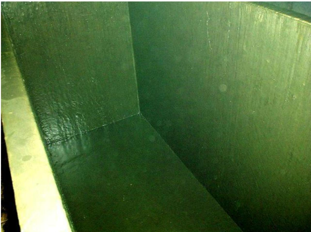
Гальваническая ванна, защищенная ламинатом «Ремохлор-МБ»
