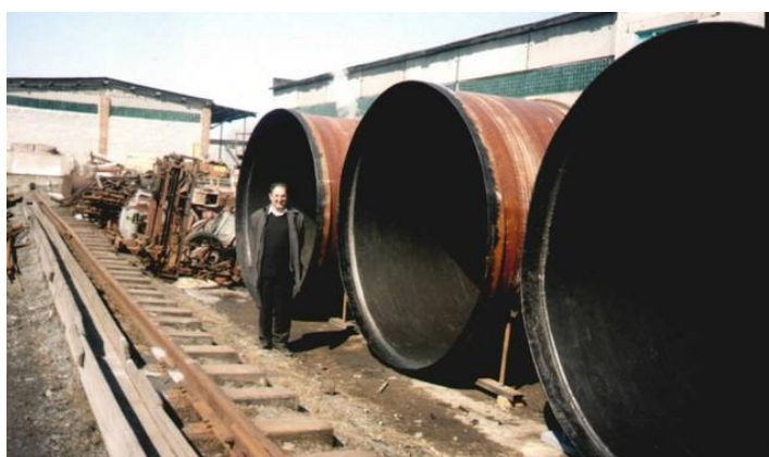
Рис 5. Стеклопластиковые трубы газоходов, защищенные композитами «Ремохлор»
